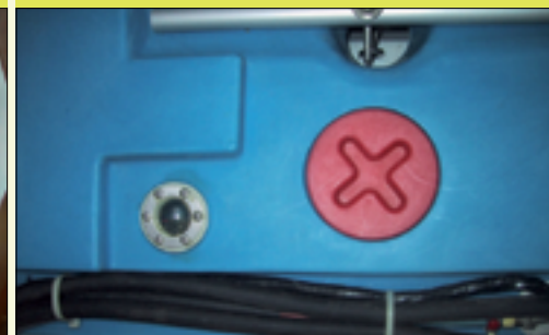
Serbatoio in plastica di ultima generazione, con tappo di ispezione e indicatore di livello a vista.
