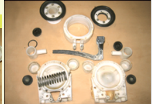
Una vista di insieme dei pezzi della membrana. I costi dei ricambi superano il costo della pompa nuova, quindi il lavoro di riparazione non è conveniente.
