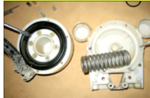
Si procede con lo smontaggio del corpo centrale.
