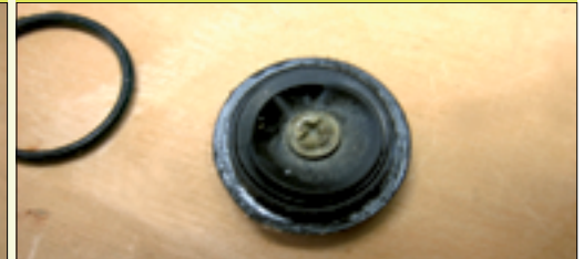
La membrana è modificata e non poteva garantire una perfetta tenuta.
