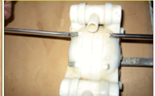
Si apre la pompa: si sospetta un'usura delle guarnizioni
